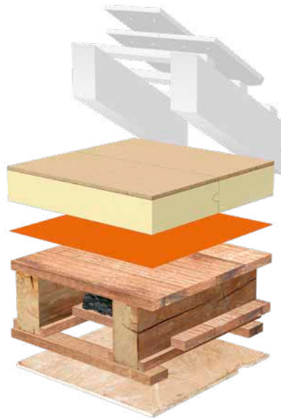
Dämmung der obersten Geschossdecke mit BauderPIR DHW auf Holzbalkendecke
