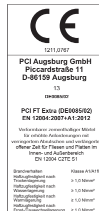
Mit PCI FT-Extra können Steingutfliesen auf der alternativen Abdichtung PCI Lastogum® sicher verlegt werden.
