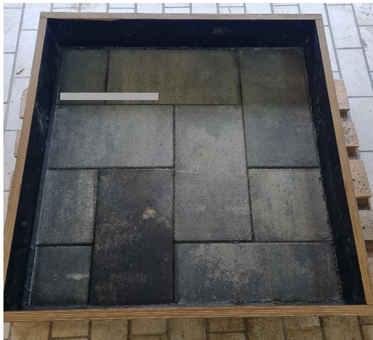
Abbildung 1: Prüffläche mit Fugenverfüllung
