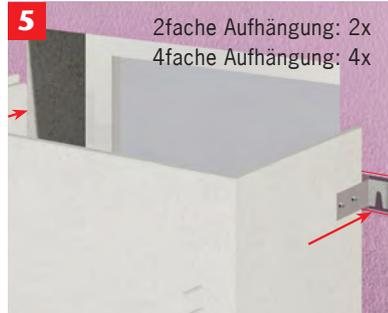
Der Lichtschacht kann nun gesetzt und fixiert werden. Bitte beachten Sie die Hinweise zum Transport und zum Versetzen in dieser Montageanleitung.
