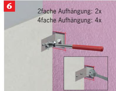
Mithilfe des Hammers können dann die Schwerlastanker bei **betonierten Wänden** gesetzt werden und die Schrauben abwechselnd mit dem Steckschlüssel angezogen werden.
