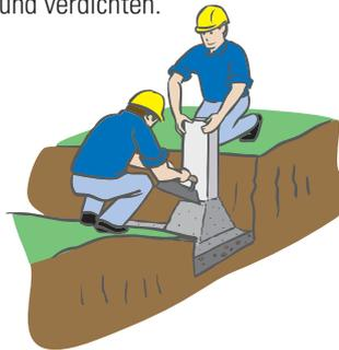
Während des Versetzens der Elemente ist auf ein sauberes Fluchten und lot-rechten Einbau zu achten. Palisaden sind fertigungsbedingt leicht konisch, sie verjüngen sich nach oben. Achten Sie deshalb beim Versetzen darauf, dass jede Palisade einzeln versetzt und ausgelotet wird. Dabei helfen kleine Holzkeile, die von oben zwischen die Palisaden gesteckt werden und diese so in der Senkrechten fixieren.
