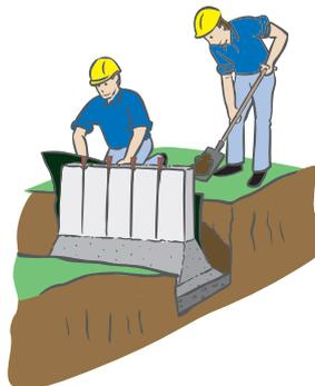
Aus optischen Gründen empfiehlt es sich, Rundpalisaden mit der Kehlung zur jeweils höheren Palisade auszurichten. Palisaden mit rückseitiger Erdanfüllung sollten zum
