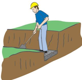
Die Palisaden werden in ein 10 – 20 cm dickes Streifenfundament aus erdfeuchtem Magerbeton (C 12/15) gesetzt.
