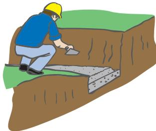
Die Palisade auf den Magerbeton aufsetzen und beidseitig bis zu 1/3 der Palisadenhöhe eine Rückenstütze mit Magerbeton auffüllen und verdichten.
