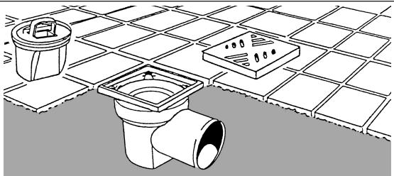
Nach Abnehmen des Rostes und Herausnehmen des Geruchsverschlusses mit integriertem Schlammeimer ist eine optimale Rohrreinigung möglich.
