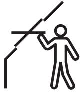
Manuelle Schwingfenster mit Obenbedienung bieten die Möglichkeit, Möbel direkt unter dem Fenster zu platzieren, ohne die Bedienung des Fensters zu beeinträchtigen. Wir empfehlen eine Einbauhöhe, die sowohl in stehender als auch in sitzender Position eine klare Sicht nach außen ermöglicht. Bitte beachten Sie, dass die optimale Fensterhöhe von der Dachneigung abhängt.
