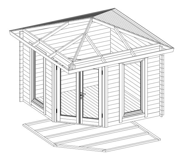
Wir empfehlen als Fundament für Ihr Gartenhaus eine vollflächig festgegründete, gepflasterte oder betonierte Fläche. Wahlweise ist auch ein Punkt- oder Streifenfundament möglich.
