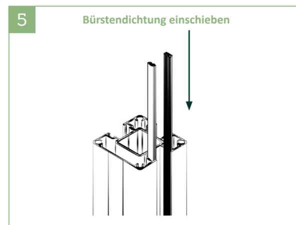
5 | Jeweils zwei der mitgelieferten Bürstendichtungen in die Pfostennuten einschieben.
