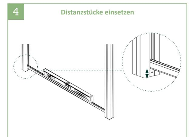
4 | Zuerst auf einer Seite das Distanzstück befestigen. Das Distanzstück der zweiten Seite mit Hilfe der U-Leiste und einer Wasserwaage ausrichten und befestigen.
