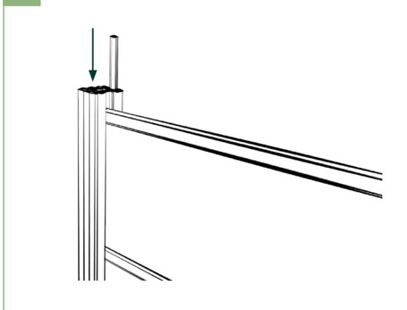
8 | Die Pfostenabdeckleisten von oben in die Pfostennut einschieben und mit der Unterkante des Pfostens bündig abschließen.
