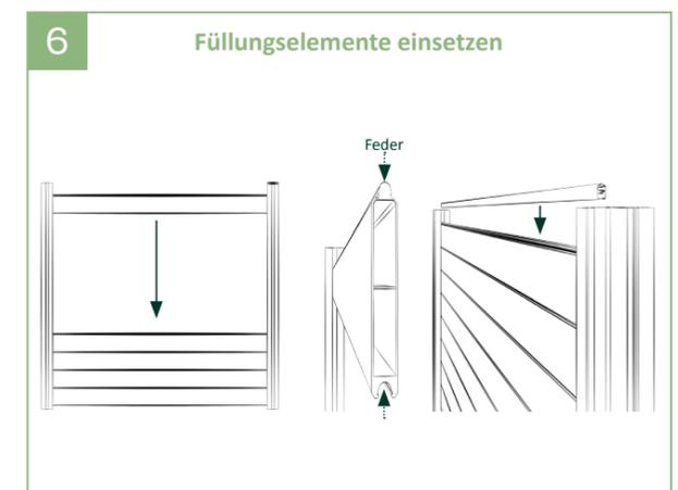
6 | Die Füllungselemente nacheinander von oben einschieben, dabei die Feder der Füllungselemente nach oben ausrichten. Mit dem Abschlussprofil abschließen.
