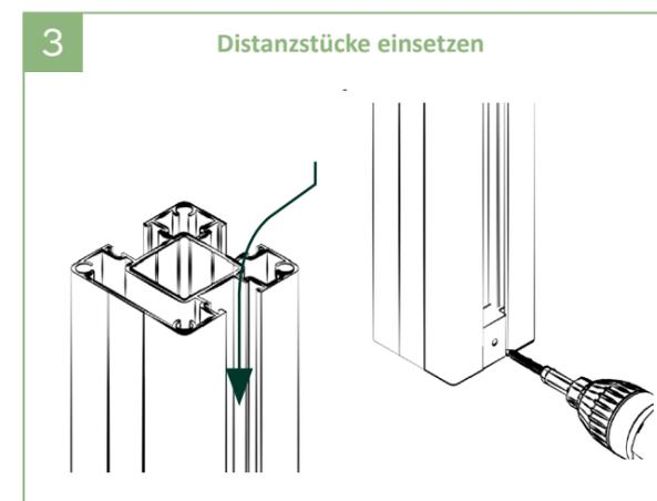
3 | Distanzstück hochkant in die Innenseite der Pfostennut einschieben, bündig mit der Unterkante des Pfostens abschließen, vorbohren und verschrauben.
