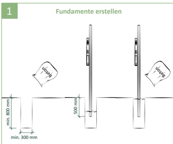
1 | Größe der Fundamente mindestens 300 x 300 x 800 mm sowie unter Berücksichtigung der Bodenbeschaffenheit.\* Ungefähr die Hälfte des Erdloches mit Beton füllen und verdichten. Anschließend die Pfosten setzen und ausrichten. Das Erdloch komplett mit Beton füllen und verdichten.
