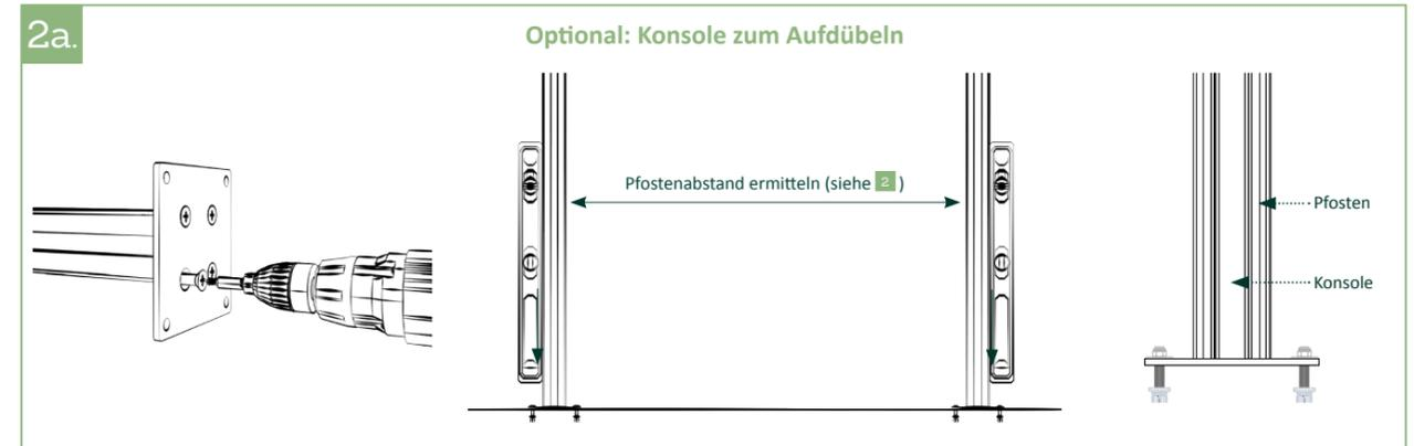
2a | Konsolen auf die Pfosten stecken und mit den mitgelieferten Schrauben von unten fest verschrauben. Ausrichtung der Konsolen bei aufgesteckten Pfosten, danach auf den Untergrund aufdübeln.
