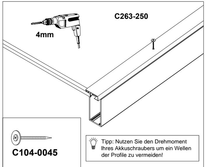
Die Doppelstepplatten und Aluminiumprofile mit den Schrauben (C104-0045) auf den mit 4mm vorgebohrten Sparren montieren. Die erste Schraube wird gemeinsam mit dem Abschlußwinkel verschraubt.
