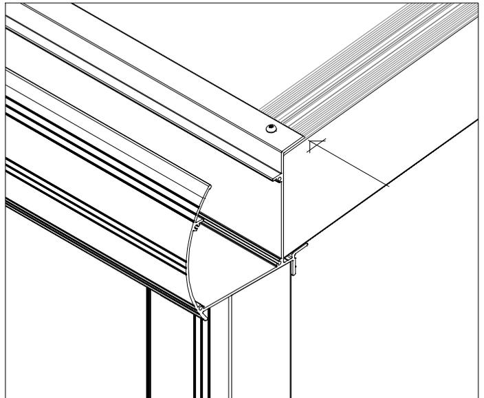
Lassen Sie das Unterlegband für die Sparren an den Profilen der Wand- und der Rinneffette bündig enden.
