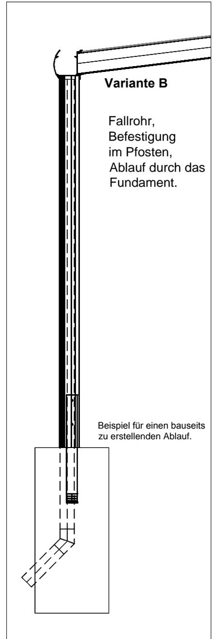
Fallrohr mit Schraubstützen, Laubfangkorb und Rohrbogen zusammenstecken, ausrichten und verkleben.
