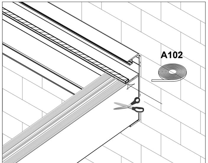
Kleben Sie das Fugenband auf die Enden des Profils der Rinne- und der Wandfette auf und schneiden es dann seitlich bündig mit den Sparren ab.
