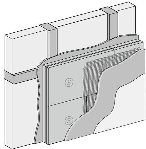
Holzfaserdämmplatte für die Innendämmung von Fachwerkhäusern und allen anderen Altbauten. Die CLAYTEC HFD Innendämmplatte wird flächig in eine Lehmputz-Ausgleichlage geklebt oder mit Lehmklebe- und Armierungsmörtel befestigt. Die weichen Platten entkoppeln Verformungen der Konstruktion vom Innenputz. Sie sind preisgünstig und für viele Außenwandarten geeignet.
