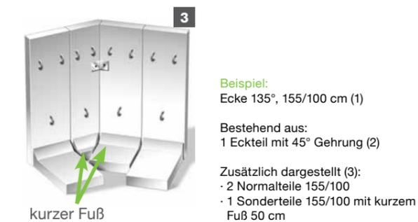
Die Versetzlänge der Eckelemente bei einer 135°-Ecke ist mit 100 cm anzusetzen.
