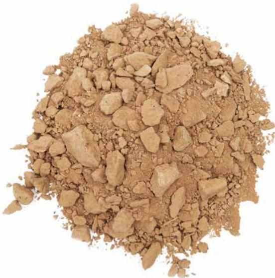
Trockene, rieselfähige Deckenschüttung. Lehm- Deckenschüttung GRANULAT besteht aus zerkleinerten Lehmsteinstücken.
