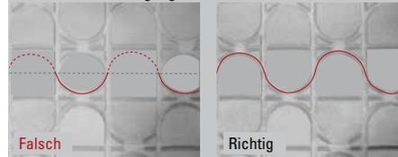
Die NORIT-TE Therm-Elemente werden von links nach rechts verlegt (siehe Beschriftung auf den Platten). Werden die Ele-
