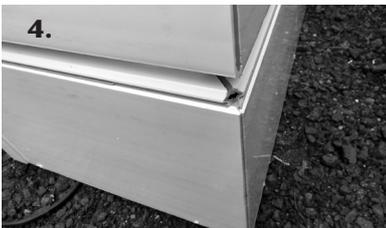
**4.** Die Aufstockelemente über das Nut- und Federsystem miteinander verklücken. Hier kann ein Hammer und eine Holzleiste (zum Schutz der Kunststoffteile) zur Hilfe genommen werden. Bitte wandseitig auf einer Seite beginnen und Stück für Stück die Verbindung herstellen.
