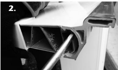
**2.** Das vordere Rostauflageprofil mit Hilfe eines Schraubendrehers entfernen. Hierbei Schraubendreher seitlich positionieren und Verklückung einseitig lösen. Im Anschluss kann das Rostauflageprofil vollständig entfernt werden.
