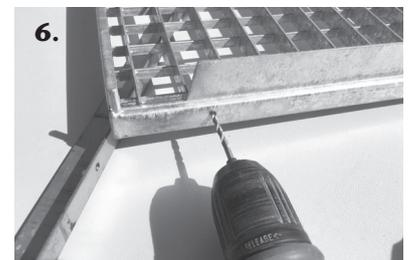
6. Mit 4 mm Bohrer vorbohren
