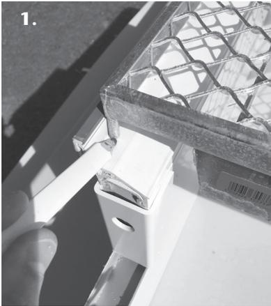
1. Verkürzter bzw. verlängerter Rost in Aufstockelement einlegen und Rostzapfen anzeichnen
