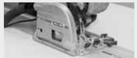
Sägen mit Handkreissäge (Drehzahlen regulierbar)
