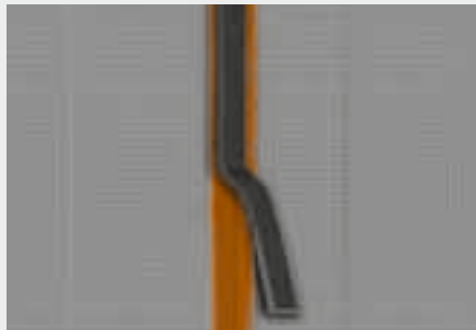
Abb. 2: fermacell Dichtband in die zuvor aufgetragene, noch feuchte fermacell Flüssigfolie drücken und direkt mit Flüssigfolie überstreichen
