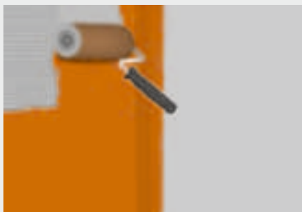
Abb. 3: fermacell Flüssigfolie mit der Rolle 2x vollflächig auftragen (Gesamtdicke mindestens 0,5 mm)
