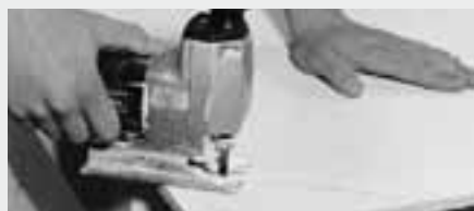
Sägen mit elektrischer Stichsäge
