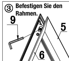
Befestigen Sie den Türrahmen mit der Türverbindung und dem Sechskantschlüssel.
