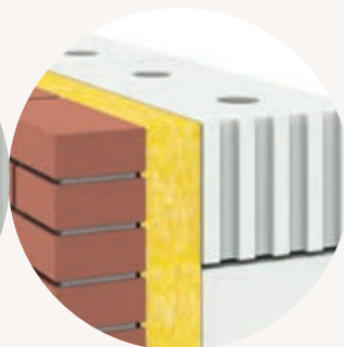
Ausführung mit Kerndämmung
