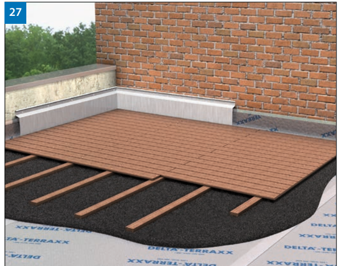
(Bild 27) Für Terrassenbeläge aus Holz oder Holzverbundstoffen wird eine Splittschüttung direkt auf die verlegte Drainagebahn aufgebracht und anschließend der Unterbau und die begehbare Fläche fertig gestellt.
