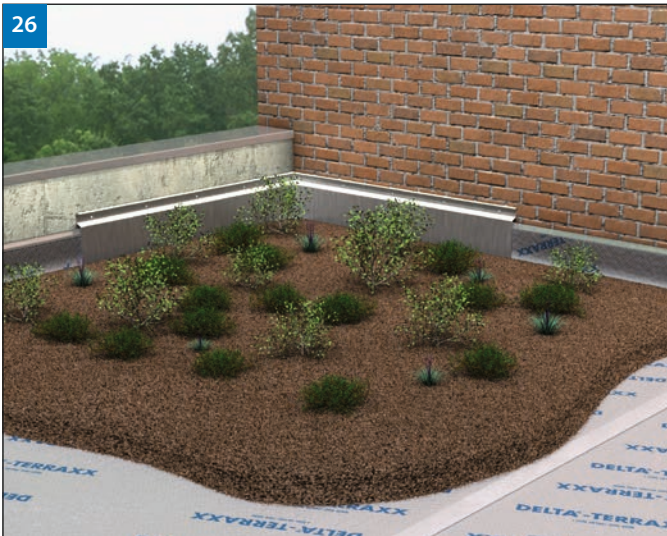
(Bild 26) Bei Dachbegrünungen kann das Pflanzsubstrat direkt in der vorgesehenen Stärke aufgebracht und entsprechend bepflanzt werden. Im Falle einer pflegearmen extensiven Begrünung sind Substratstärken von 8 bis max. 15 cm sinnvoll, bei intensiven Begrünungen werden je nach Bepflanzung Substratstärken größer 20 cm bis 100 cm verwendet.
