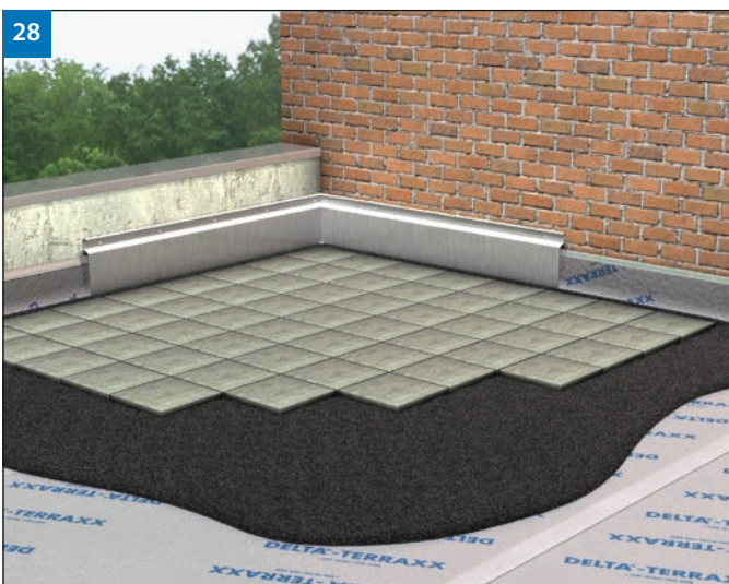
(Bild 28) Bei begehbaren Flächen, auf ebenen und festen Untergründen, wird die Splittschüttung direkt auf der verlegten Dränbahn aufgebracht und anschließend der begehbare Plattenbelag fertig gestellt.
