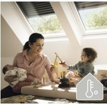
VELUX ACTIVE schließt die VELUX INTEGRA® Rollläden und Hitzeschutz-Markisen aufgrund externer Wetterdaten automatisch, um vor Überhitzung zu schützen und öffnet Fenster, wenn sich die Raumtemperatur dadurch senken lässt.
