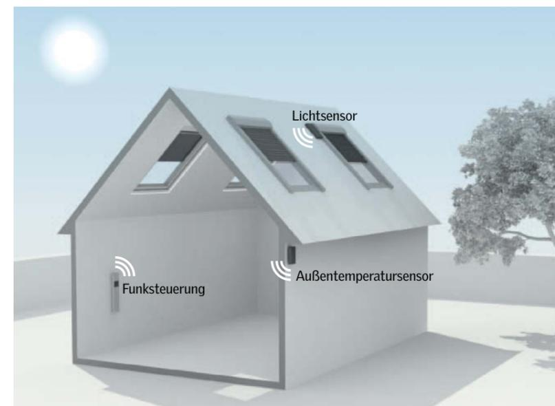
Durch die einzigartige Verknüpfung von Licht- und Außentemperaturdaten kann die Automatik des VELUX INTEGRA® Sensorsystem Sonnenschutzes das ganze Jahr intelligent für natürliches Raumklima sorgen: Während andere Systeme oft z. B. nur die Lichtintensität messen, erkennt die VELUX Lösung gerade in den Übergangszeiten Frühjahr und Herbst, ob vor Hitze geschützt werden muss oder ein positiver Wärmeeintrag durch geöffneten Sonnenschutz Heizkosten senken kann.
