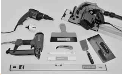
Bild 6: Werkzeuge zur Bearbeitung von FERMACELL Firepanel A1
