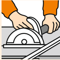
Bild 3: Sägen mit Handkreissäge
