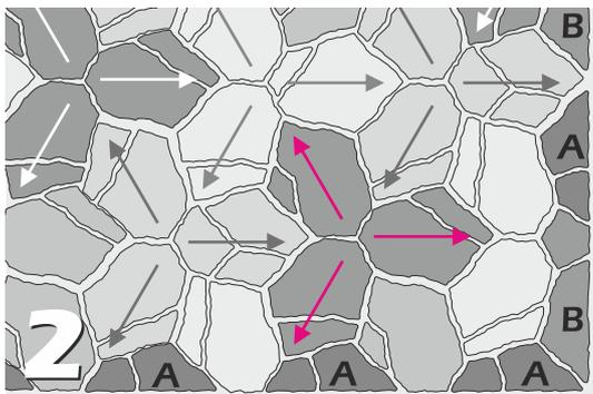
Einfache Verlegung der Basissteine: Aufgrund der sechseckigen Polygonalform wird jeder Stein um 120° (links oder rechts herum) zum Nachbarstein hin gedreht. Tipp: Eine Dreiergruppe ergibt immer eine Blütenform.
