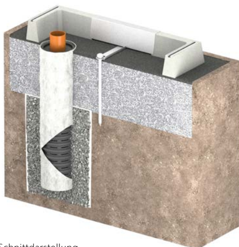
Schnittdarstellung Sickerrohr ohne Wärmepumpe
