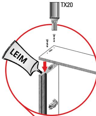
**2** Rahmen in Wand einsetzen und ausrichten:
