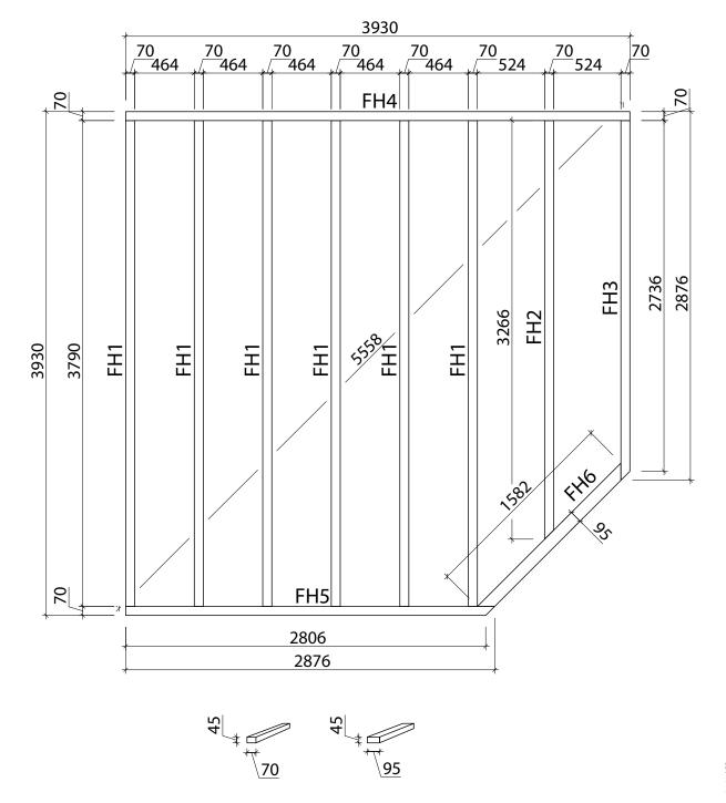
Ukse montaaž / Tür montage / Door assembly (GH+ / SH)
