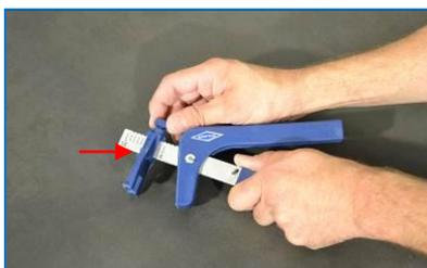
7. An der zum System gehörenden Spannzange ist die jeweilige Fliesenstärke einzustellen. Der verstellbare vordere Anschlag ist dabei an der Zahlenskala auszurichten. Feststellschraube gut anziehen.
