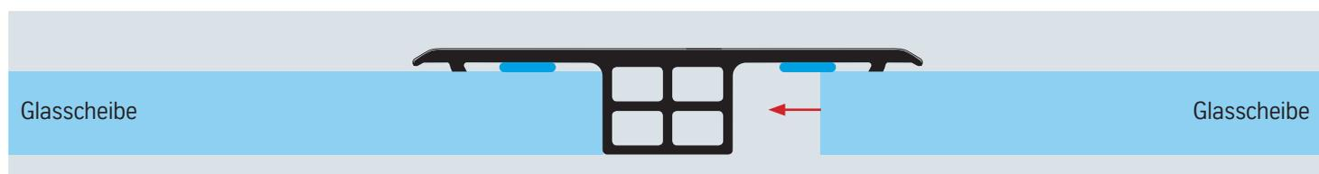
Die waagerechten Kanten des Fugenbands müssen mit dem Plexisil HPPS Silikon-Dichtstoff verschlossen werden. Dies muss an den senkrechten Stößen zu den Kedern in den Aluminiumprofilen wiederholt werden.
