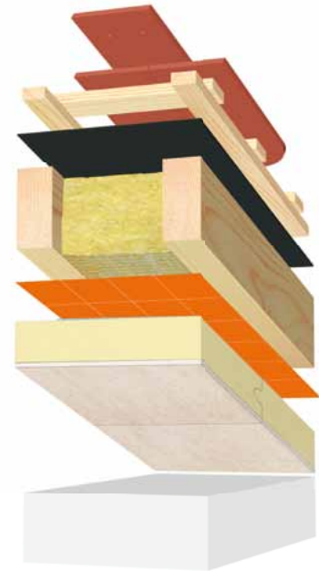
Untersparrendämmung mit BauderPIR DGF im Neubau
