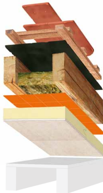
Untersparrendämmung mit BauderPIR DGF in der Sanierung
