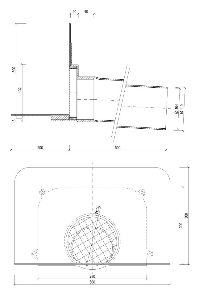
KF 6541-2 Flavent® Attika-/Balkonablauf DN 100 mit Bitumen-Manschette
