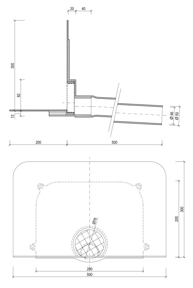
KF 6526-2 Flavent® Attika-/Balkonablauf DN 50 mit Bitumen-Manschette
