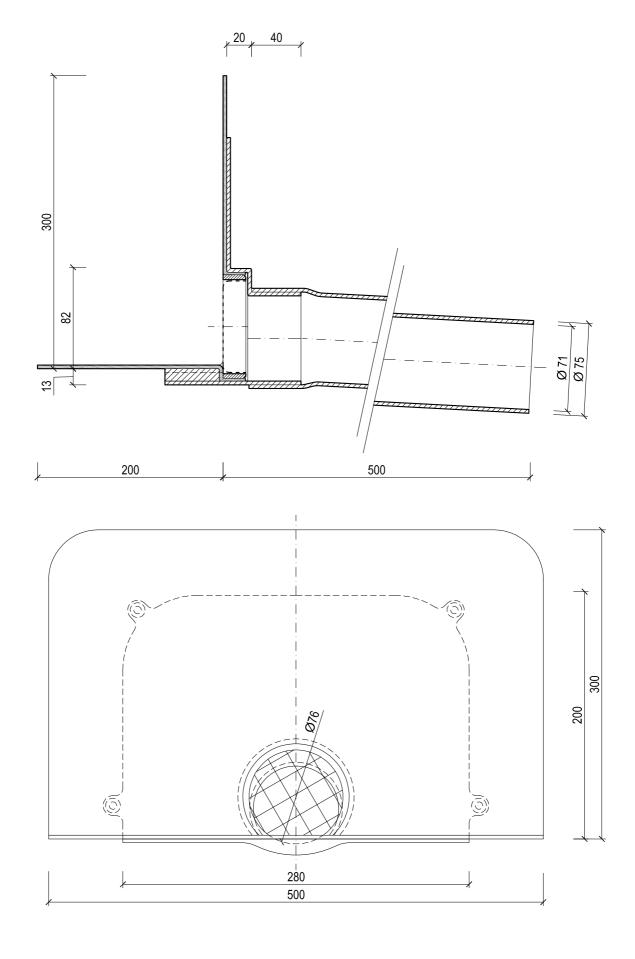
KF 6531-2 Flavent® Attika-/Balkonablauf DN 70 mit Bitumen-Manschette
