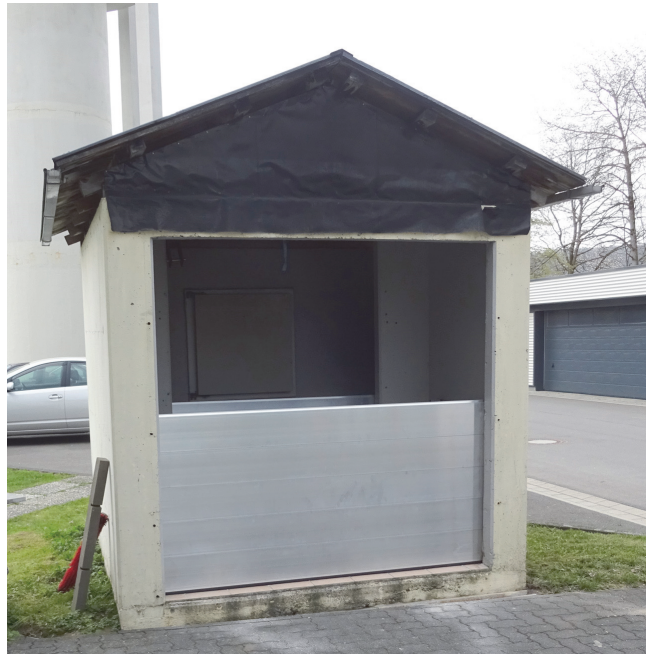
Abbildung 2.1: Versuchsgebäude für Test und Optimierung von mobilen Hochwasserschutzsystemen für den Objektschutz (mit der eingebauten Schutzwand b_2 = 200 cm; h = 1,0 m)
