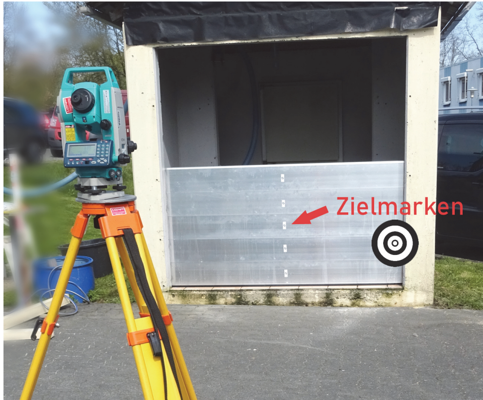
Abbildung 3.2: Messung der horizontalen Durchbiegung des HWS-Systems mittels Laser- Tachymeter
