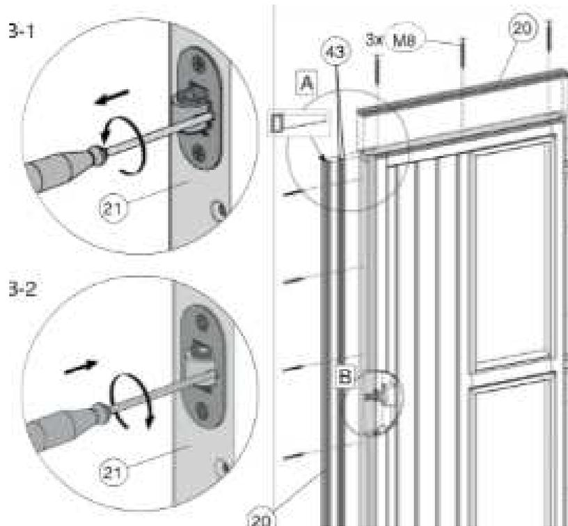
In Extremfällen wird es notwendig, das Schließblech um 2-3 mm zu versetzen und ggf. anschließend die Rolle in der Tiefe zu justieren.
