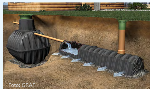
Foto: GRAF Regenwassernutzung mit nachgeschalteter Rigolen-Versickerung.
